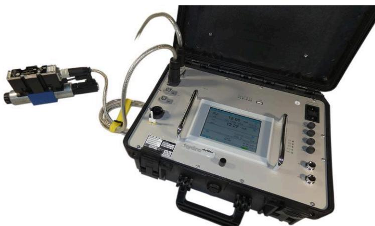
Bosch Rexroth 4WREE6 Proportionalventil mit 4..12..20mA Schnittstellen ohne 24V Freigabesignal
