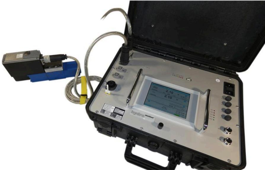
Bosch Rexroth 4WRSEH6 Regelventil mit  $\pm 10V$  Schnittstellen ohne 24V Freigabesignal
