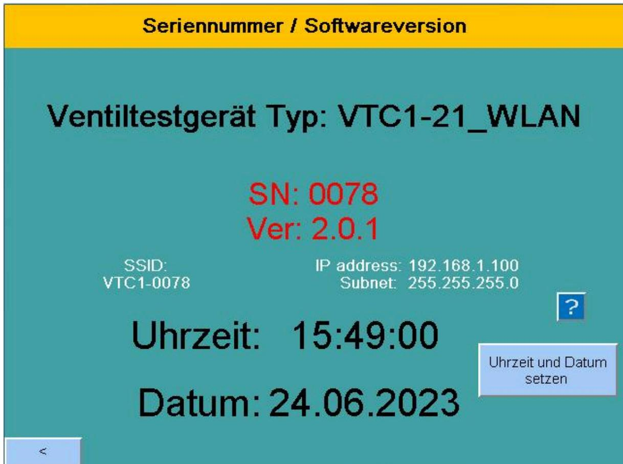
Mit der entsprechenden Suchfunktion ihres Devices (Mobiltelefon, Tablet, Laptop, ...) suchen Sie zuerst die verfügbaren WLAN-Netzwerke und wählen anschließend die **SSID-Kennung** ihres Ventilttestgerätes aus.
