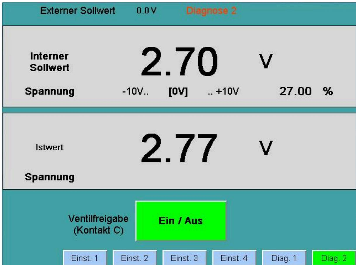
Im Menü [Diagnose 2] werden nur die analogen Ventilsignale und der Schaltzustand des Freigabesignals angezeigt.
