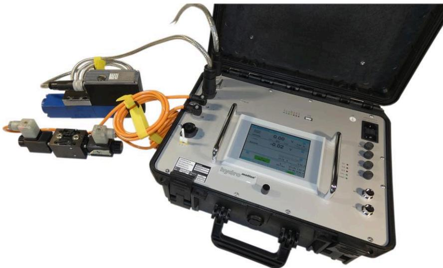
Bosch Rexroth Regelventil und HAWE 4/3-Wege Schaltventil mit 24V Schaltmagnete
