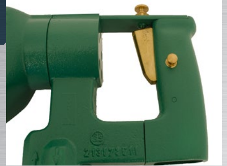
Handgriff mit Einschaltperre und Arretierung
