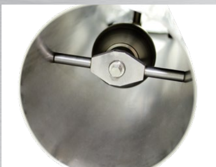
Saugbereich mit Venturidüse
