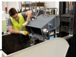
**abnehmbarer Spänebehälter** für die externe Entsorgung
