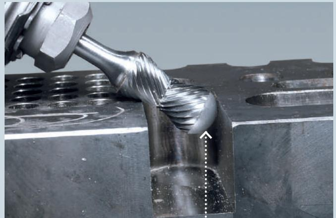
Der Radius an der Spitze des Frässtifts dient als Führung und Abstützung. Beschädigungen am Werkstück werden vermieden.
