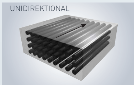
UNIDIREKTIONAL Faserverlauf in eine Richtung Fibre progress in one direction
