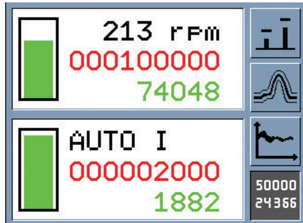
**Auftrag- und Werkzeugstandmengen** mit Soll- und Istmenge sowie aktuelle Hubzahl.
