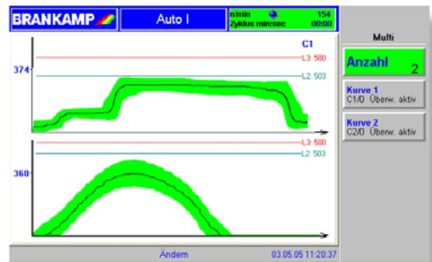
Werkzeug mittels Hüllkurven überwachen
