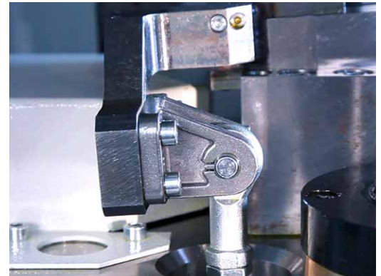
Hydraulisches Spannsystem für die Vorschubstange
